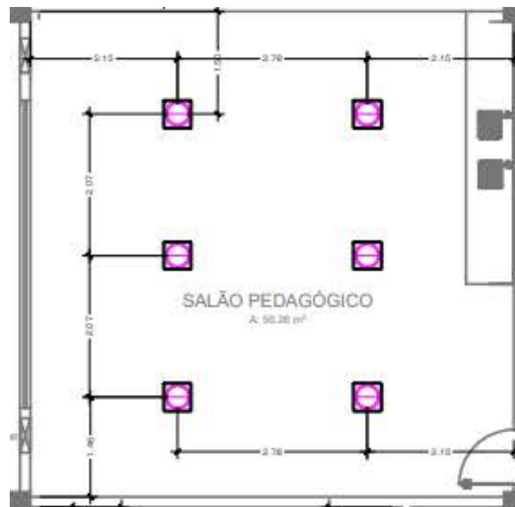
PLANTA BAIXA LOCAÇÃO ILUMINAÇÃO
