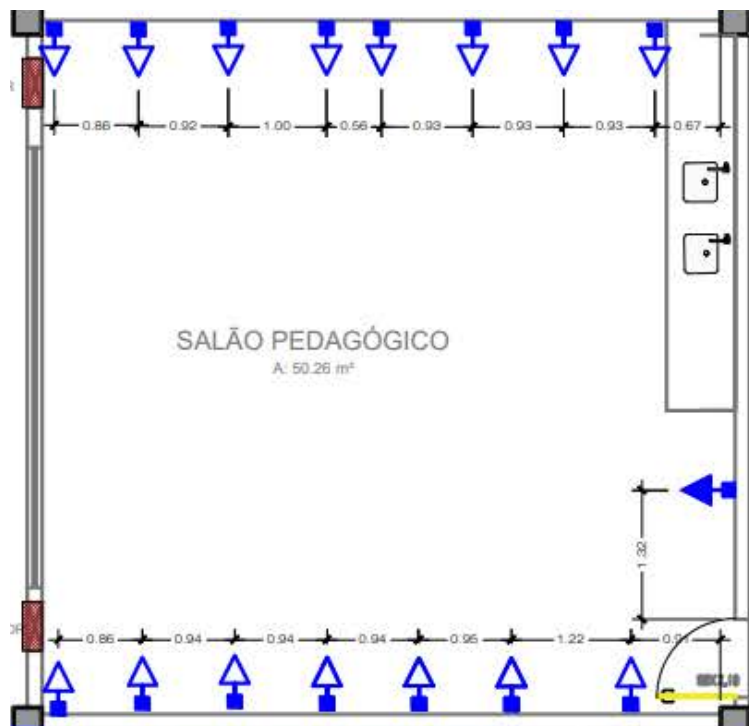
PLANTA BAIXA INDICAÇÃO NOVAS TOMADAS
